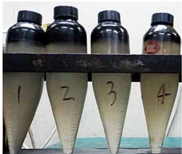
图5 非离子清水剂与阴离子清水剂分段复合加药 加药量从左至右: 75, 100, 150, 200mg/L
