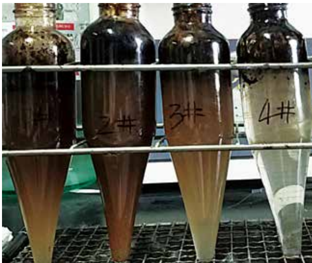
图4 阴离子清水剂一次加药清水情况 加药量从左至右: 100, 75, 150, 200mg/L
