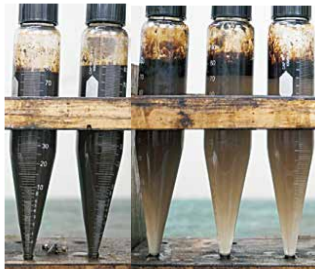
图3 非离子清水剂一次加药清水情况 加药量从左至右: 0, 50, 100, 150, 200mg/L
