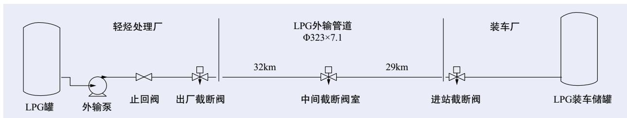
图3 某液化石油气管道输送系统典型流程图
