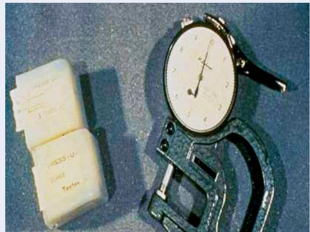
复制胶带法检测粗糙度
