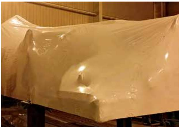
图6 模块热塑薄膜收缩包装示例
