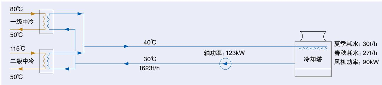
图2 仅水冷不发电运行参数
