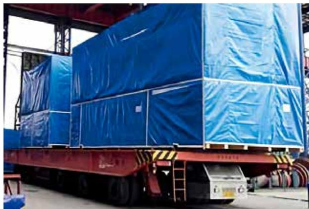
图1 第一种木箱包装加雨布包裹包装示例
