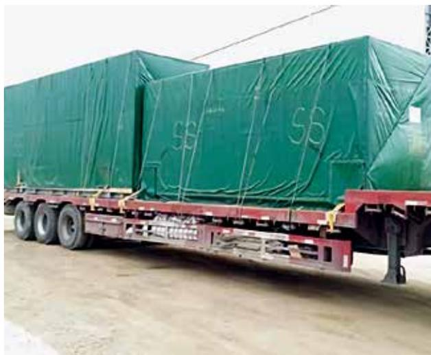
图2 第二种木箱包装加雨布包裹包装示例
