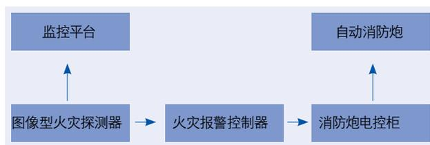
图1 图像火灾探测报警系统原理图
