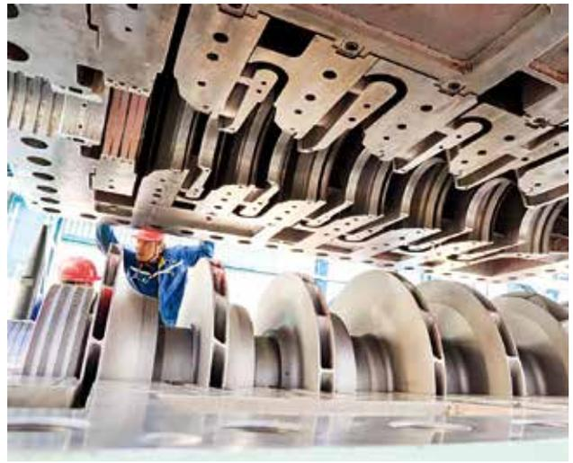
裂解气压缩机低压缸转子试装
