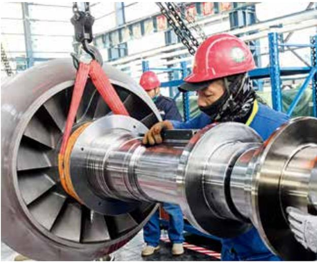
裂解气压缩机中压缸转子水平度测量
