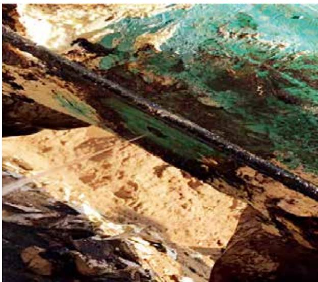
图2 净化油管道腐蚀泄漏
