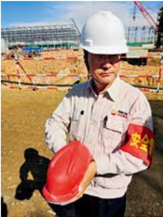
现场检查发现的5元一顶的安全帽,用手轻轻一挤,立马变形
