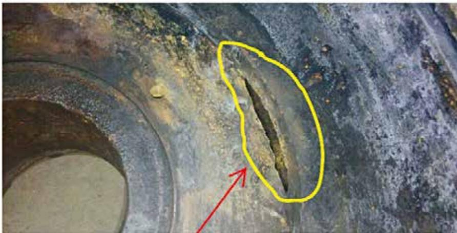
A泵壳体存在长约80mm, 宽7mm的裂缝。
