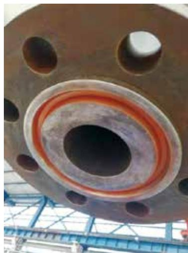
图3 法兰环槽密封面与金属环垫用红丹粉做接触线检查
