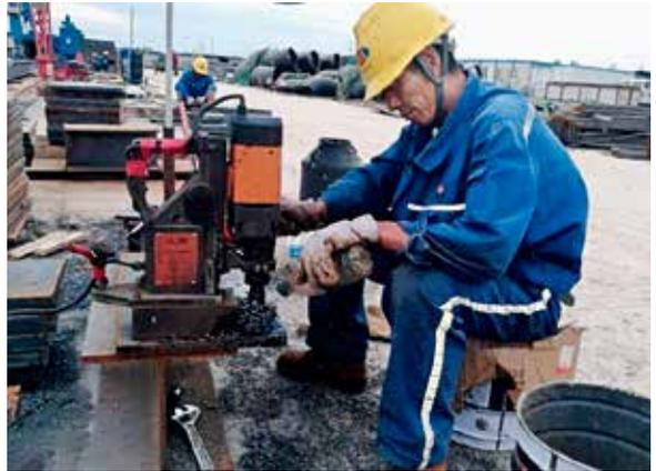
作业人员操作台式电钻未带护目镜、违规带手套操作
