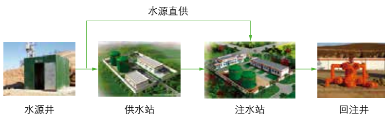
图1 长庆油田供水流程示意图
