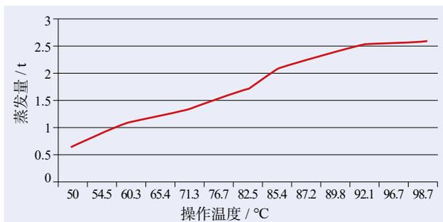
图4 操作温度对蒸发量的影响
